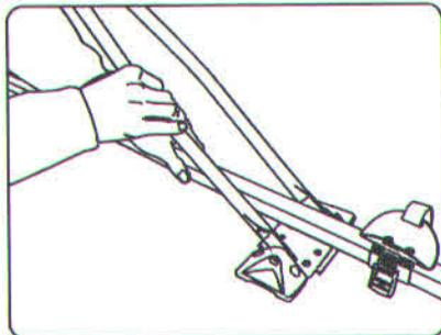
4. Соедините несущую балку в сборе и кронштейн в помощью двух крепёжных скоб. Между скобой и балкой проложите резиновый п-образный профиль, отрезав его по длине. С нижней стороны кронштейна на резьбу скоб навинтите, не затягивая, гайки М6 с шайбами.
