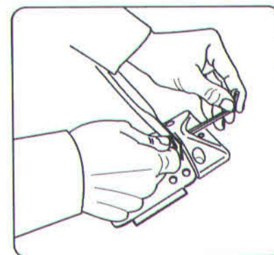
1.1. При установке велокрепления на **аэродинамические дуги** с Т-профилем, обойма не применяется. Соедините кронштейн со штангой посредством винта и затяните Г-образным ключом.
