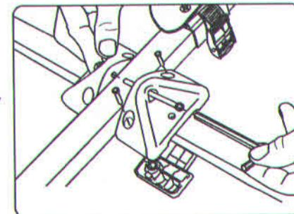
3. Снизу наденьте на заднюю дугу две нижних части обоймы и соедините обойму винтами.
