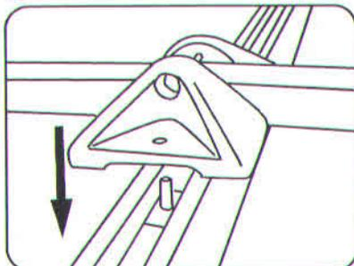
5. Установите на несущую балку крепления в месте пересечения её с задней поперечной дугой багажника таким образом, чтобы винты переходников проходили через отверстия. Зафиксируйте винты гайками.
