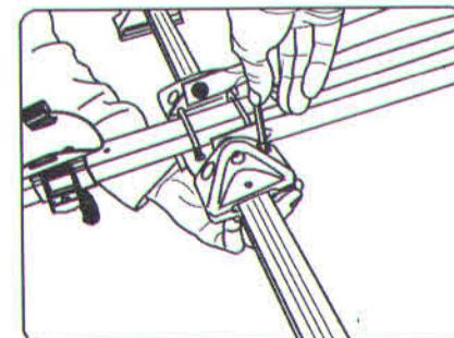
4. Также зафиксируйте нижние части обоймы на передней дуге.
